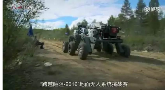
图 15：采用特殊悬挂架构的 6 台轮毂电机全电驱动无人驾驶载具
